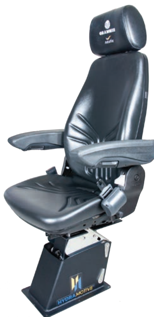
Avento 722 overdel montert med Hydramotive HM-Z søyle, armlener, setebelte og nakkestøtte.
