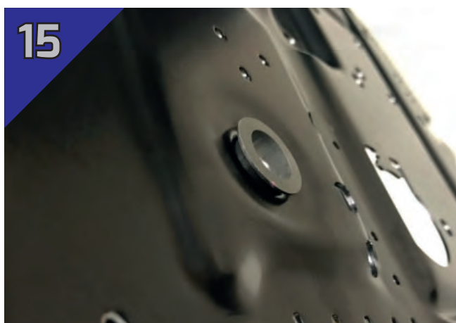
15 Trykk på plass plastforingen i senterhullet i bunnen av setetoppen. Monteres fra undersiden, og trykkes helt inn.
