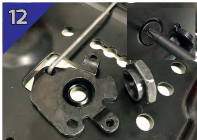
12 Fest låsehendelen til setetoppen med spesialmutteren og skruen. Begge tilpasset kongen på hullet.
